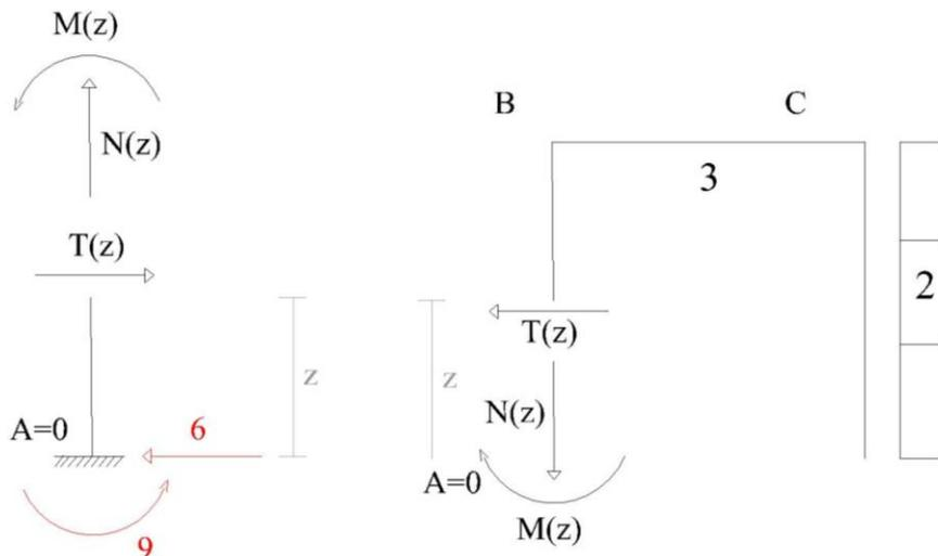
Fig. 8 – Tratto di trave da considerare per determinare le funzioni CdS. (sin) Opzione A-z. (dx) Opzione z-D
