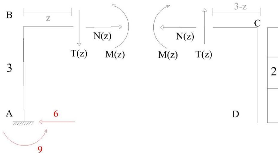
Figura 9 – Tratto di trave da considerare per determinare le funzioni CdS. (sin) Opzione A-z. (dx) Opzione z-D
