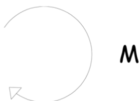
Figura 29. Simbolo usato per convenzione per indicare una coppia
