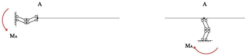
Figura 7. Il vincolo doppio-doppio pendolo reagisce con una coppia
