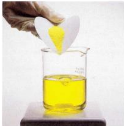
Figura 1.15 Una miscela omogenea o soluzione. Un composto solido giallo, il cromato di potassio, è versato in acqua: agitando, esso si scioglie formando una soluzione acquosa. (C.D. Winters)
