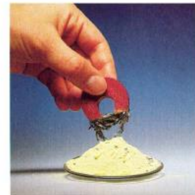
Figura 1.16 Le scaglie di ferro in una miscela di ferro e zolfo possono essere separate rimescolando la miscela eterogenea con un magnete. (C.D. Winters)
