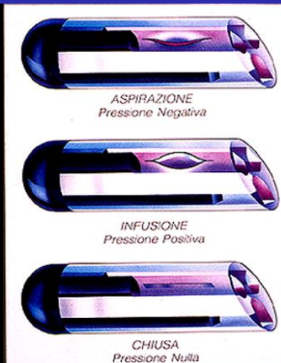
Funzionamento della valvola Groshong
