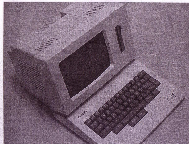
Figura 2.1 Il Canon Cat. Si notino i due tasti LEAP al disotto della barra spaziatrice.
