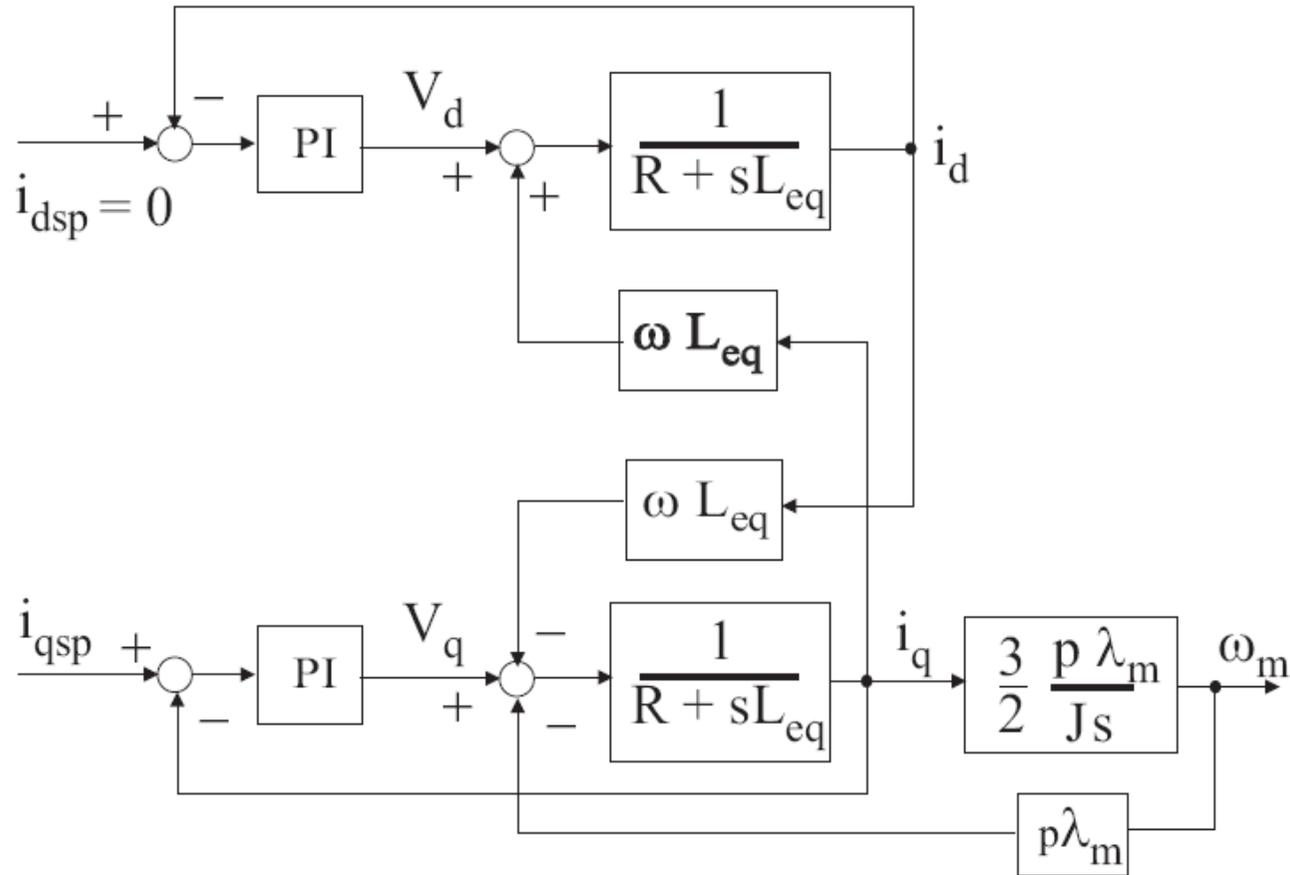
La retroazione di corrente elimina anche la f.e.m. ( $\omega \lambda_m$ ) come nel motore in corrente continua.
