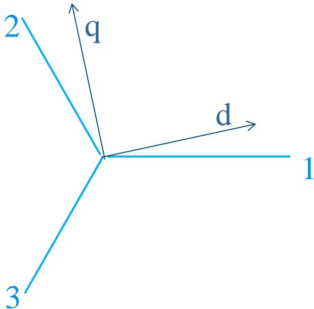
Meglio usare  $i_q$ , dato che nel sistema trifase la corrente ha un andamento sinusoidale (a regime) oppure più contorto (in transitorio), invece nel sistema (d,q)  $i_q$  è proporzionale alla coppia  $T$  istante per istante, in qualsiasi condizione.
