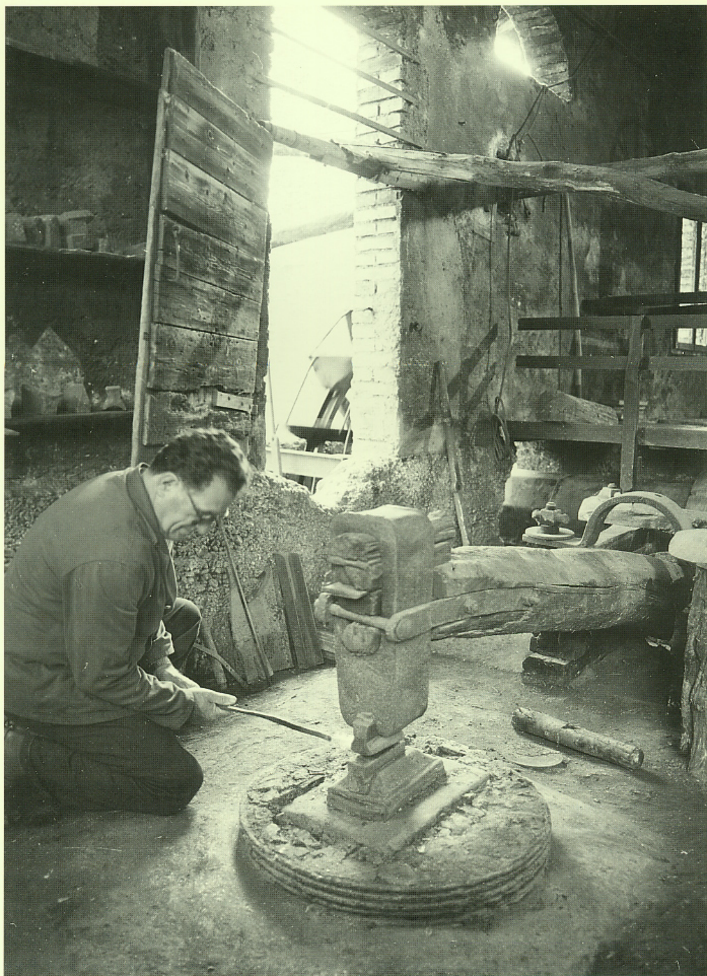
Celotto al lavoro sul maglio. La testa del "martello" si sta abbattendo con forza sul ferro da sagomare, mentre si vede la rosta che continua a girare mossa dall'energia provocata dal salto d'acqua
