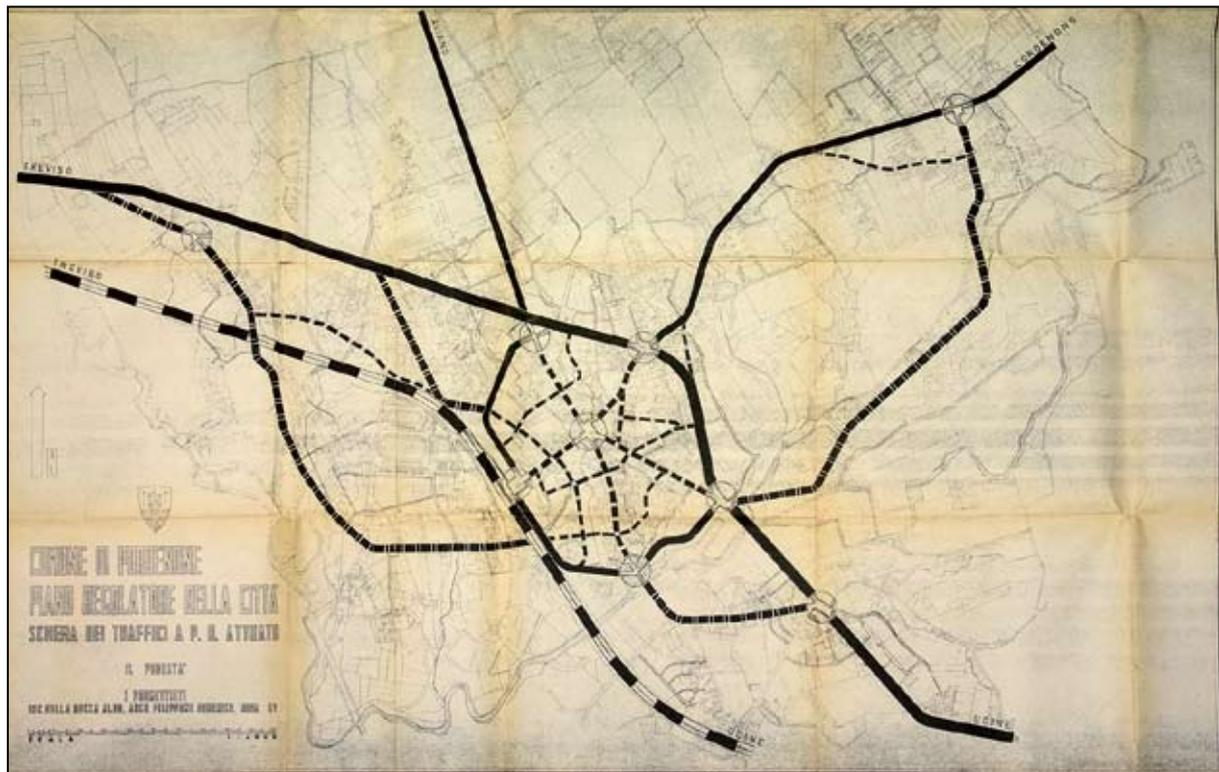
Schema del traffico che individua la chiusura della circonvallazione con la costruzione della Traversa interna e di via Rivierasca
