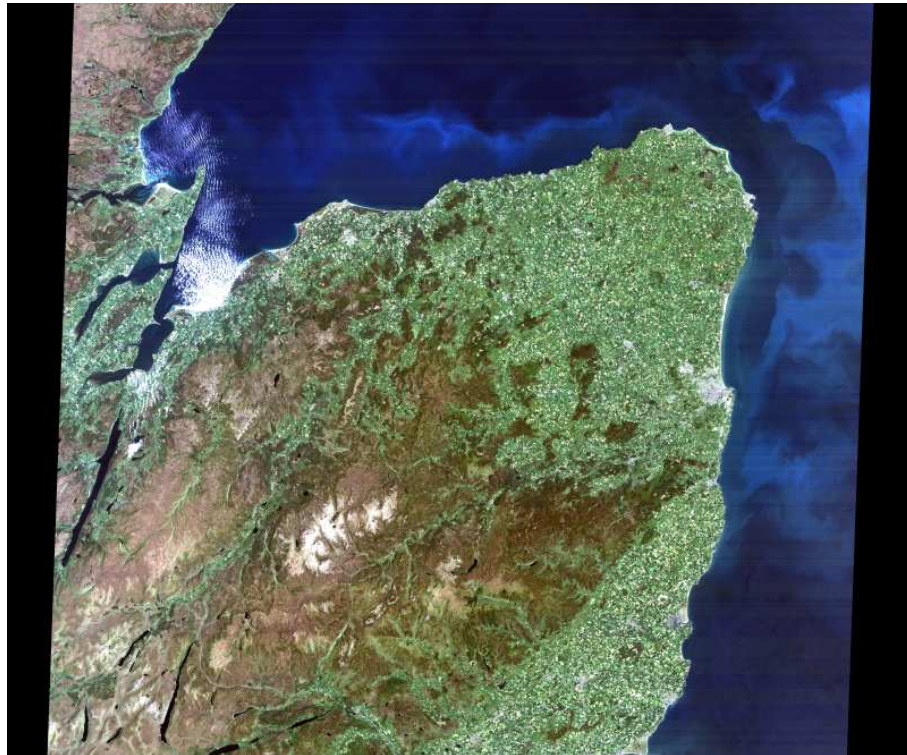
Figura 3.9: Archivio Landsat CEOS (LN5-cal.zip): combinazione RGB delle bande 3,2,1. Immagine acquisita dal sensore TM il 25 Marzo 2003.
