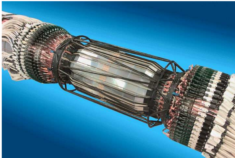
Figura 2.7: SVT completamente assemblato. Sono visibili i sensori al Silicio dello strato più esterno e la struttura di supporto in fibra di carbonio che li circonda.
