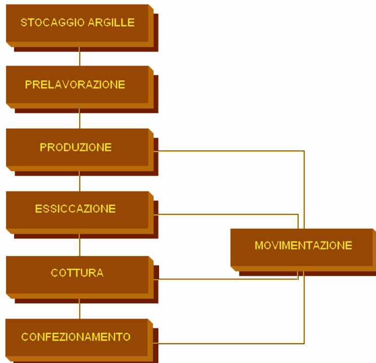
Figura 1.1: Schema generale del processo produttivo dei laterizi
