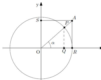
Graficamente la tangente rappresenta il segmento orientato  $\overline{RA}$  mentre la cotangente rappresenta il segmento orientato  $\overline{SA}$ .
