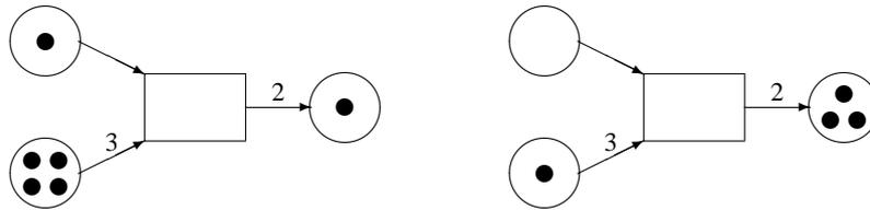
Figura 2: Stato di una rete posti/transizioni prima e dopo la transizione
