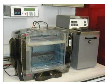
Assemblamento del gel di PAA nella camera per la 2° dimensione
