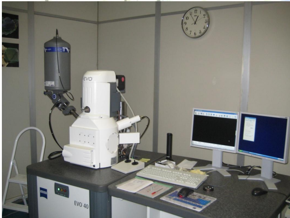
Microscopio elettronico a scansione (SEM) con microanalisi (EDX).
