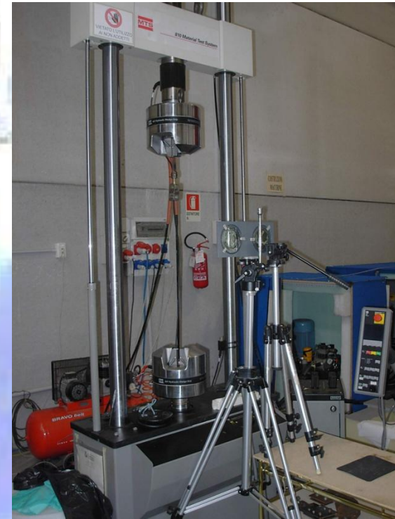
Macchina servo-idraulica per prova materiali +/- 250kN (trazione, compressione, fatica).
