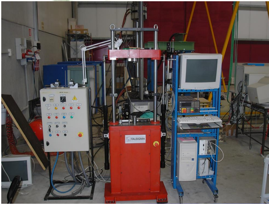
Macchina servo-idraulica per prova materiali +/- 20kN (trazione, compressione, fatica).
