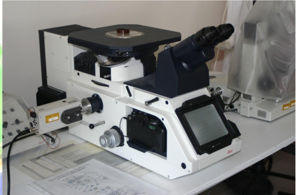
Microscopio metallografico con corredo ottico completo di luce polarizzata, contrasto di fase interferenziale, telecamera ed analisi di immagine.
