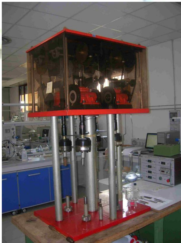
Macchina di trazione utilizzabile per indagini di corrosione sotto tensione (SCC) .
