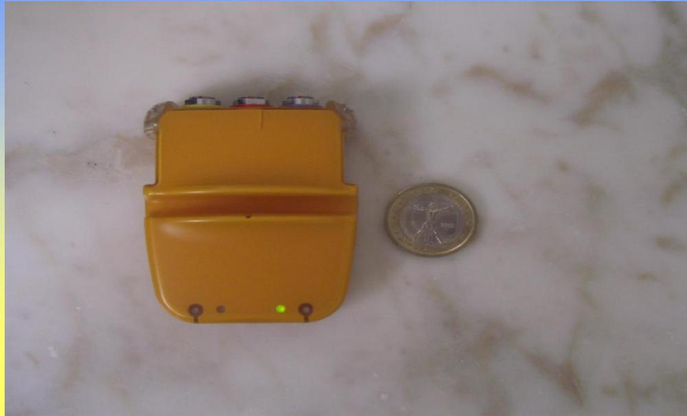
Accelerometro piezoelettrico triassiale ( dimensioni 7X 5X 2 cm. ) con sensibilità di 0,006 m/sec<sup>2</sup> e frequenza di campionamento di 20Hz , collegato a computer portatile HP Compaq nx9420 tramite wireless Bluetooth ( banda di trasmissione 2,4 GHz; velocità max. di trasmissione 720 Kbit/sec ).
