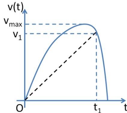
$$a = \Delta v / \Delta t = (v_1 - v_0) / (t_1 - t_0)$$
