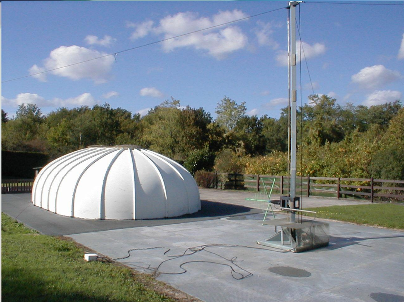
Site de mesure en espace libre
