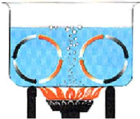
La quantità di calore scambiata,  $\Delta Q$ , dalla superficie di un corpo solido a un fluido, in un tempo infinitesimo  $\Delta t$ , dipende dall'area della superficie di contatto  $A$ , e dalla differenza di temperatura,  $\Delta T$ , tra quest'ultima e il fluido.
